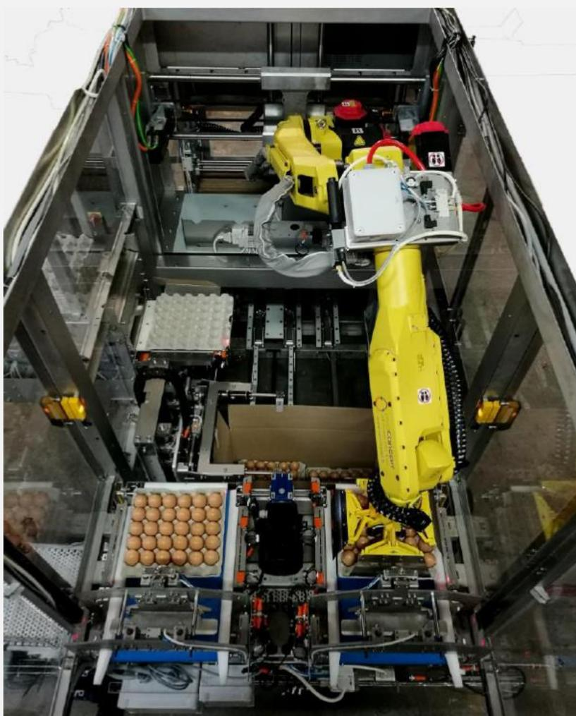
Cellule robotisée avec formeuse de caisses intégrée spécialement conçue pour l'encaissage d'alvéoles et boîtes en caisses fermées
